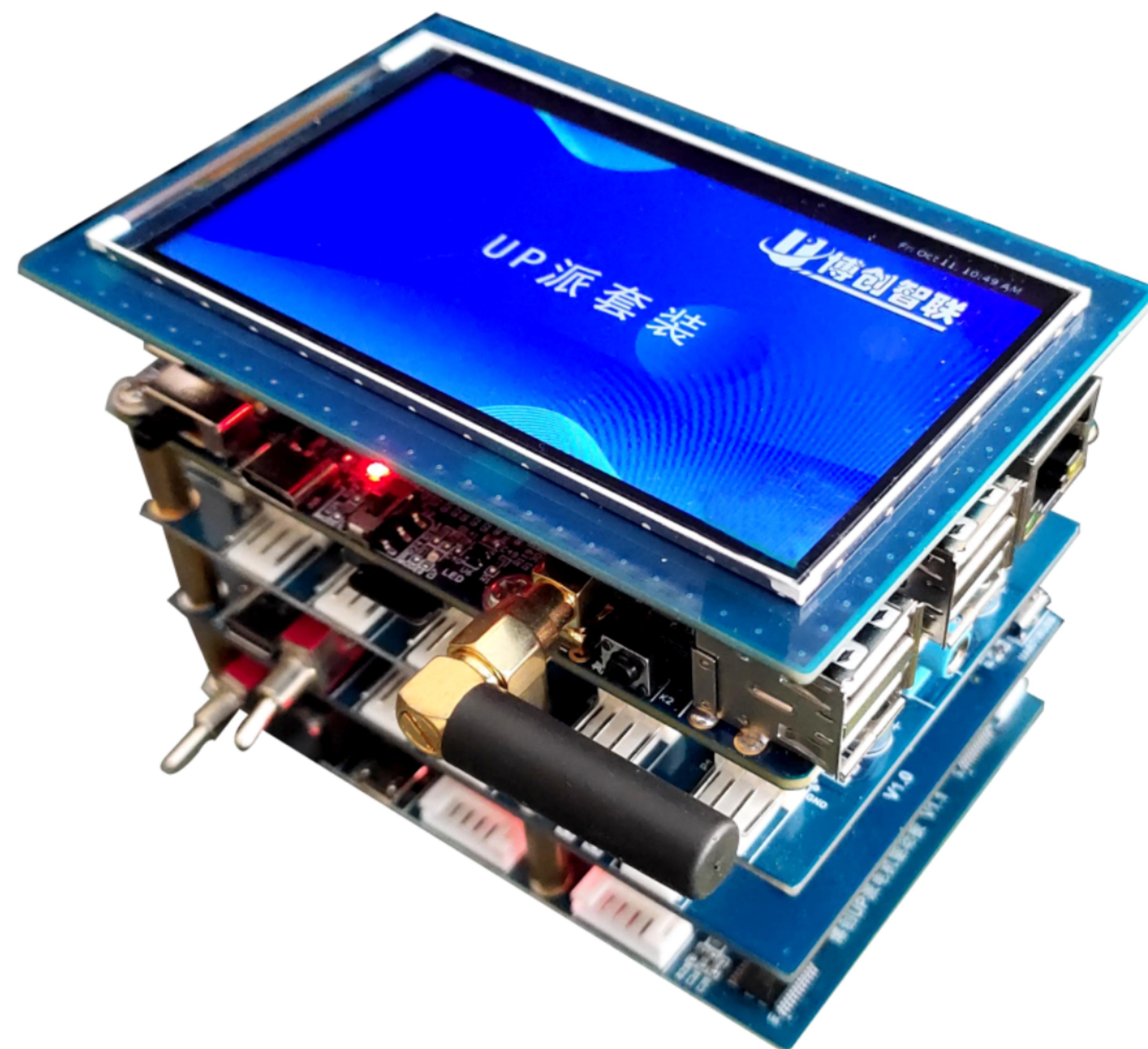
UP派套装由UP派主板、UP派电机驱动板、UP派扩展板、UP派STM32子板构成。可结合实际的应用场景选择其中的一个或者多个子板灵活组建。UP派套装可应用于自然语言处理、图像处理、多媒体处理、机器人控制等领域。家居精灵UP-Home-Spirit8就是基于UP派套装而组建的一台集嵌入式、人工智能、机器人、物联网于一身的机器人。
